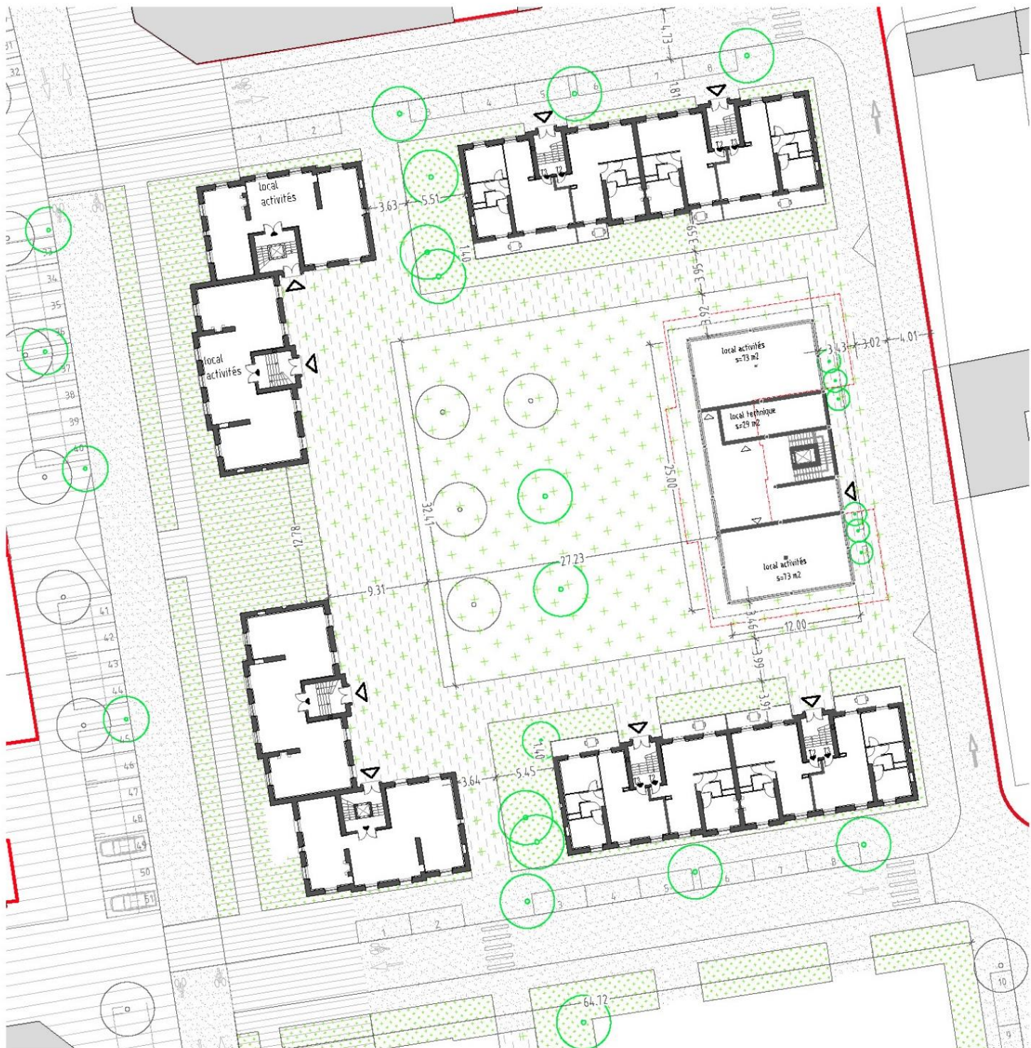
Plan des RDC de l'îlot Nord, avec l'emprise du nouveau bâtiment et le rappel de l'emprise du bâtiment U démolì.
